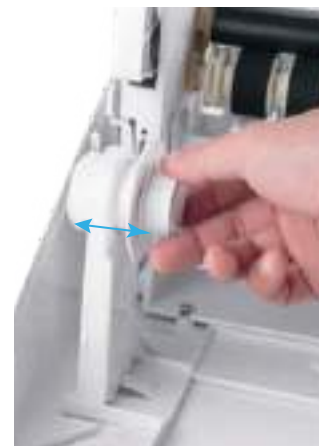
Tornillo ajustable que se adapta a diferentes longitudes de rollo de papel
